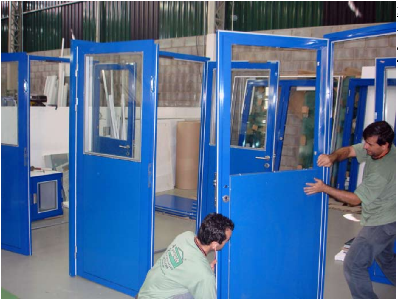
Pré-montagem de portas de abrir 1 e 2 folhas com visor SL50 da As Montec
