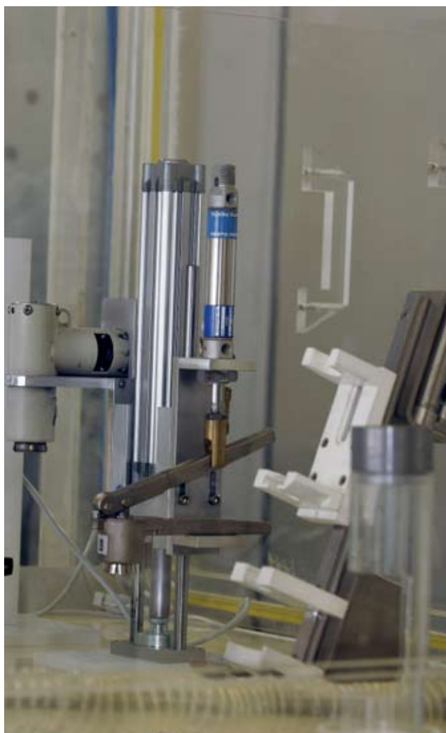
Dispositivos internos, comuns às celas de produção de radiofármacos, necessários às simulações para condição de ensaio “em repouso”
